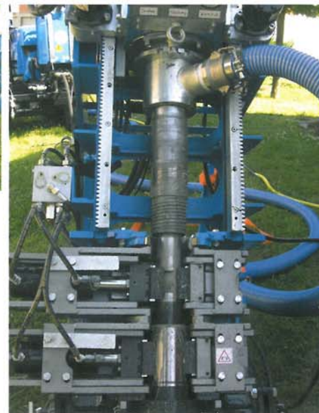
Gestängeklemmung mit Absaugung.
