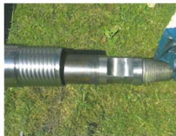
Das Überbohrrohr mit Bohrgestänge.
